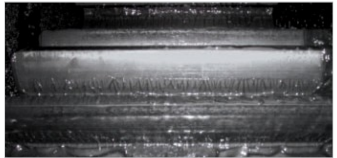
使用BERULIT EL 420於7天後窯傳動的齒面
